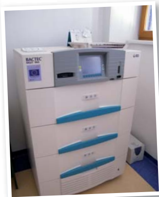
Do zrekonštruovaných priestorov oddelenia klinickej mikrobiológie bol umiestnený automatizovaný systém na testovanie mykobaktérií BACTEC.
